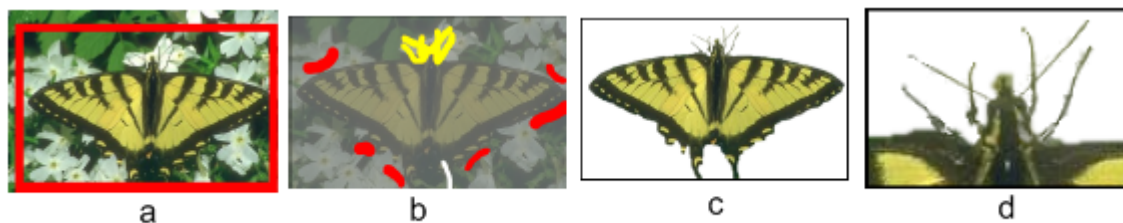
Figuur 2.11: (a) Invoer en annotatie van de voorgrond (b) Extra aanduidingen van voorgrond en achtergrond (c) Resultaat (d) Detail van de voorkant van het resultaat (Rother et al. 2004).
