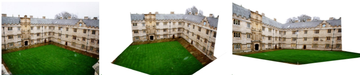
Figuur 2.20: Voorbeeld van het pop-upalgoritme. De eerste afbeelding is de invoer. De andere twee geven de scene weer vanuit een ander standpunt, waarbij de 3D-eigenschappen zijn berekend uit de originele foto. (Hoiem et al. 2005).
